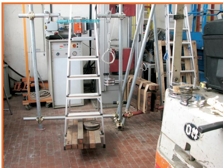
Figura 4.3 - 1 Prova di instabilità laterale su scala doppia
